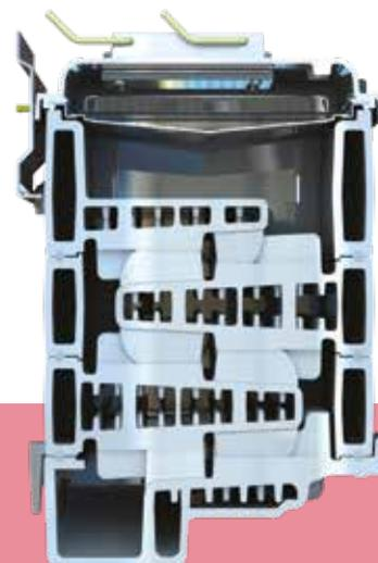
Le caldaie **THEA'S FAMILY** sono dotate di scambiatore "monometal" in alluminio, modulare, completamente ispezionabile sia sul lato fumi che sul lato acqua ad elevata superficie di scambio; di bruciatore in fibra metallica a fiamma inversa e di sistemi di miscelazione ad altissima efficacia e accessibilità.
